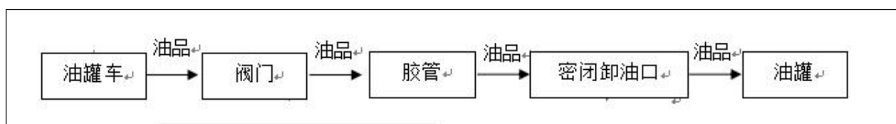
图 2.2-4 柴油卸油工艺流程图
