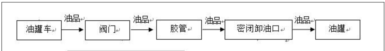
图 2.2-4 柴油卸油工艺流程图
